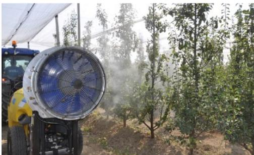
In cosa consiste l'innovazione. Il ventilatore può essere posizionato a diverse altezze a seconda della pianta da irrorare. Inoltre, la pompa a membrana è montata sulla parte del timone sterzante che è collegata al trattore, in modo che l'angolazione dell'albero cardanico sia mantenuta costante in curva.
