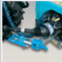
Timone sterzante TSS al traino della trattrice Steering drawbar TSS for tractor towing Enganche giratorio TSS de arraste del tractor
