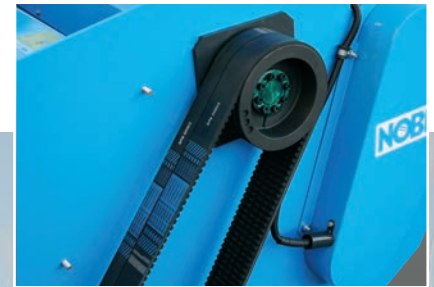
Cinghie Powerband per trasmissioni di grande potenza Powerband belts for high power transmissions Correas Powerband por transmisiones de gran potencia
