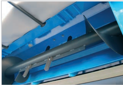
Doppia coclea per creare andane di biomassa Double auger to create biomass windrows Coclea doble para crear hileras de biomasa
