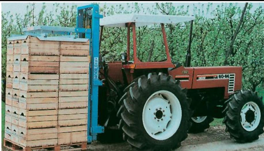
Gli elevatori portati ME 20/320 sono applicabili posteriormente alla trattrice, con montanti in profilato estruso in acciaio speciale.
