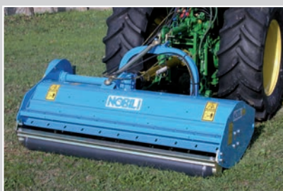
Telaio con struttura tubolare e cofano apribile per manutenzione Tubular structure frame and hinged hood for maintenance Chasis con estructura tubular y posible apertura de la trampilla para mantenimiento
