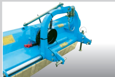
Spostamento laterale meccanico o idraulico Manual or hydraulic side shift Desplazamiento lateral mecánico o hidráulico
