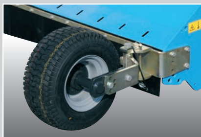
Ruote sterzanti in gomma. Rubber steering wheels Ruedas móviles en goma
