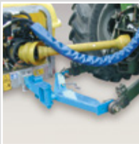
Timone sterzante ai bracci del sollevatore Steering drawbar for lifting unit arms Enganche giratorio para brazos del levantador
