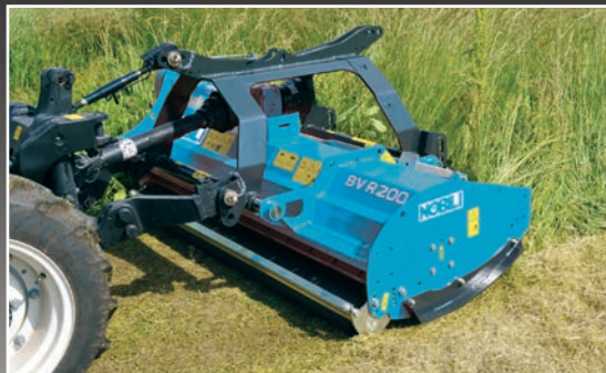
BVR serie 100 – Trinciatura più omogenea in posizione frontale poiché il trattore non calpesta la vegetazione BVR series 100 - More homogeneous shredding in the front position since the tractor does not step the vegetation BVR serie 100 - Trituración más homogénea en versión frontal en cuanto el tractor no rueda por encima de la vegetación
