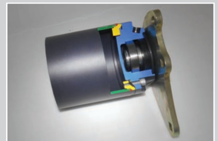
Rullo a fondelli smontabili con cuscinetti a bagno di grasso e con raschifango Roller with life-greased removable ends and mud scraper Rodillo de componentes desmontables con engrase de por vida y limpia rodillo
