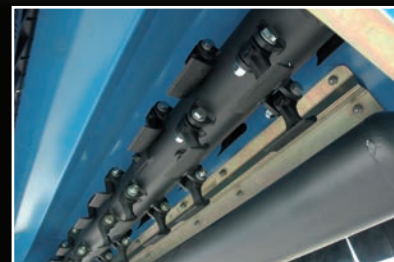
Rotore equilibrato dinamicamente ai massimi regimi di lavoro della macchina Dynamically balanced rotor at maximum working rates conceived for the machine Rotor equilibrado dinamicamente a los máximos regímenes de trabajo de la máquina
