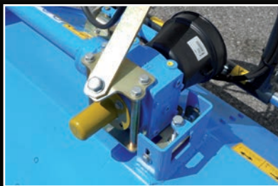
Gruppo rinvio con ruota libera e doppia albero in entrata a 540 o 1000 giri Gearbox with free wheel and double input shaft at 540 or 1000 rpm Caja con rueda libre integrada y doble eje en entrada a 540 o 1000 rpm
