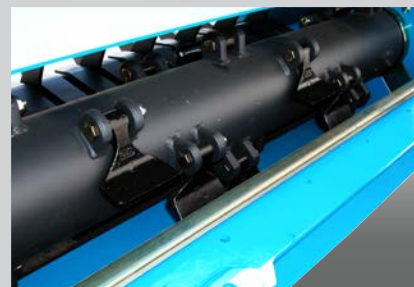
Rotore di grosse dimensioni con 8 file di mazze per la triturazione dei sarmenti fino a 10 cm di diametro. Controcottelli lisci smontabili Large dimensions rotor with 8-hammer rows for mulching branches up to 10 cm in diameter. Removable straight counter-knives Rotor de gran tamaño con 8 filas de martillos cuchara para la tritución de restos hasta 10 cm de diámetro. Contra-cuchillas rectas desmontables
