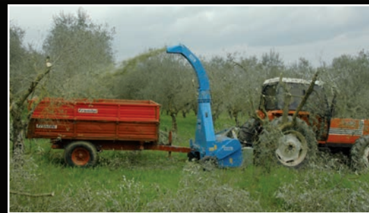
TRP-CV Regolazione idraulica del flusso dei sarmenti tritutati TRP-CV Hydraulic adjustment of mulched pruning flow rate TRP-CV Regulación hidráulica del flujo de poda triturada
