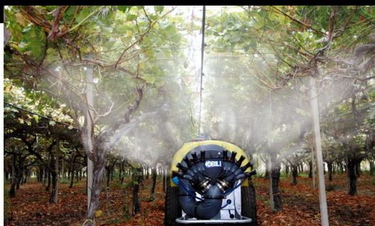
La gamma VENTIS portato si rinnova, riducendo gli ingombri e migliorando l'ergonomia. Pensata per terreni con forte pendenza e ridotti spazi di manovra, mantiene inalterate le caratteristiche tecniche che hanno reso il nebulizzatore di NOBILI la soluzione ottimale per l'irrorazione del vigneto. Atomizzatori pneumatici portati, ideali per trattamenti a basso volume su vigneti, frutteti e uliveti.
