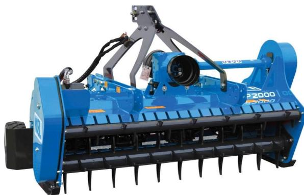
Caratteristica peculiare del rotore XP sono i supporti dentati che portano i perni dei coltelli e che sono saldati sul tubo rotore seguendo una doppia elica. Nella triturazione di grosse andane o di sarmenti di grossa dimensione quando i coltelli mobili indietreggiano a causa dei colpi ricevuti, i supporti dentati sopperiscono alla momentanea assenza del taglio della mazza agendo essi
