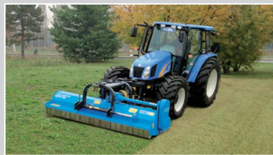
BPR serie 10 - Trinciatura più omogenea in posizione frontale poiché il trattore non calpesta la vegetazione. BPR series 10 - A more homogeneous shredding quality when front-connected because the tractor doesn't roll over plants. BPR serie 10 – Trituración más homogénea si se utiliza en versión frontal, en cuanto el tractor no rueda por encima de los vegetales.
