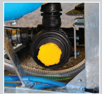
Filtro di aspirazione esterno con valvola antisvuotamento, predisposto per riempimento.
