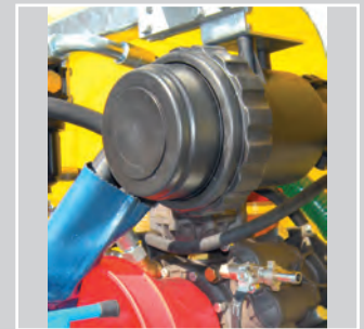
Filtro di aspirazione con valvola
