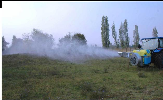
SR dispone anche di una rotazione della bocca di uscita di 110° sul piano verticale e di 210° sul piano orizzontale, entrambe idrauliche.
