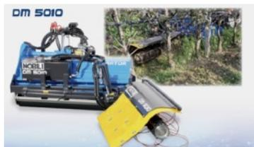
L'attrezzatura è dotata di un rotore con fili lunghi di nylon in grado di eliminare
