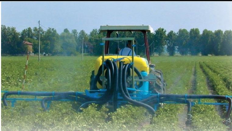
Le barre da 10 metri, sono movimentate da due pistoni idraulici con 4 movimenti indipendenti e dotate di 8 o 10 moduli di irrorazione completamente regolabili in base al sesto di impianto da trattare.
