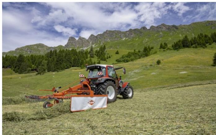
La testata a elevata oscillazione angolare di circa 48° impedisce lo slittamento delle ruote sul terreno, proteggendo così il tappeto vegetale. Le ruote montate in tandem sono disponibili come optional per terreni poco livellati. È disponibile una ruota anteriore girevole per adattarsi ancor meglio alle irregolarità del terreno, limitando così l'incorporazione di impurità nel foraggio.
