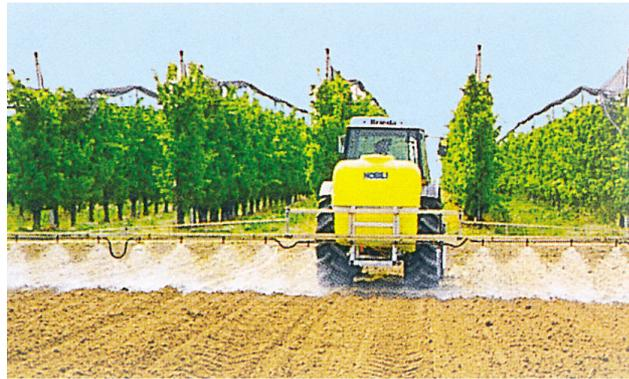
Le barre sono zincate a caldo, con protezioni anti urto sui bracci terminali, aste in inox (50 cm di interasse) getti singoli con membrana anti goccia, ugelli in plastica, collegamenti oleo dinamici con 2 coppie di attacchi rapidi
