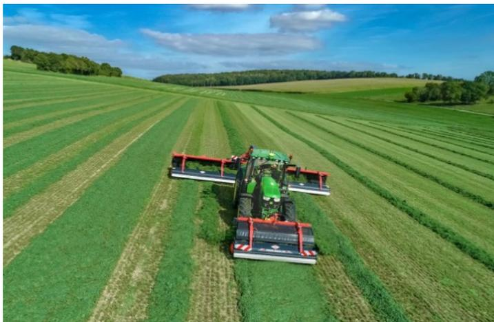
Il modello MERGE MAXX 440F è dotato di un tappeto largo circa 1 m che consente di ottimizzare il trasporto del foraggio e la formazione dell'andana laterale. La regolazione della tensione del tappeto è centralizzata e non richiede l'uso di attrezzi.
